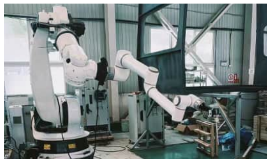
Integration mit Industrieroboter für die Lackierung von Buskarrosserien
