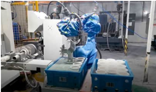
Pick-and-Place von Salzkernen mit Vision-System
