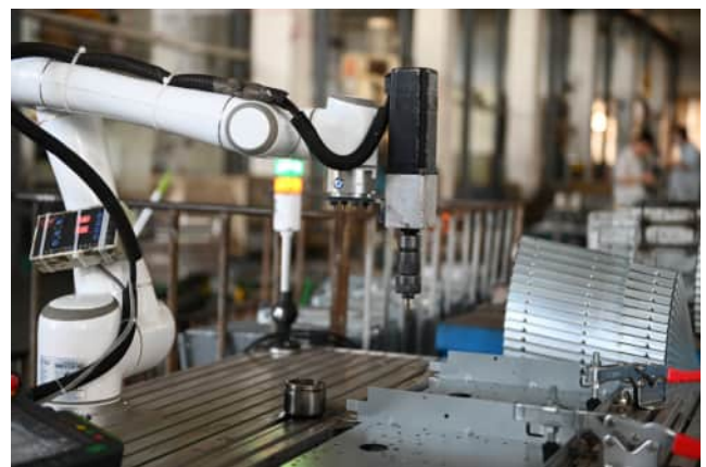
Bohren von Blechen
