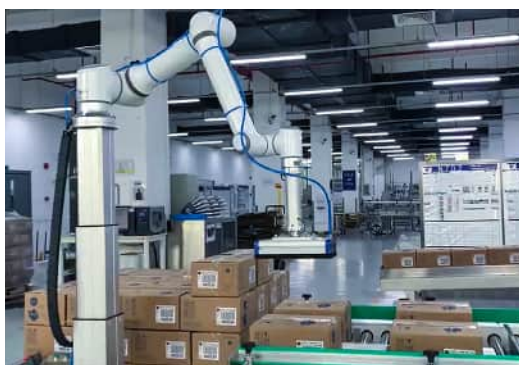
Palettieren mit Hubsäule und kundenspezifischer Greifererweiterung
