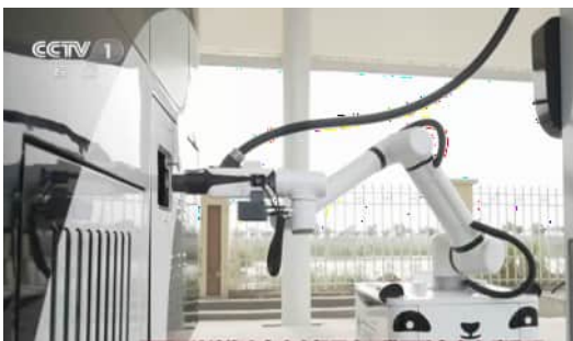
Laden von Elektroautos mit AGV
