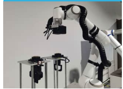
Gimatic EQC (elektrischer Schnellwechsler) Greifer
